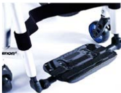
XES050132 Pedana unica regolabile in angolazione con appoggiapiedi in fibra di carbonio, regolabile in angolazione e profondità, ribaltabile lateralmente con cinghia fermapolpacci
