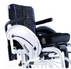
XES040117 Bracciali tubolari imbottiti estraibili swing away in alluminio (apribili lateralmente)
