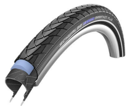
Dekk, luft, punkteringsbeskyttet, Schwalbe Marathon Plus Evolution
