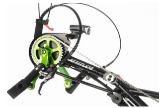
Vork, hoek en diepte instelbare crank (Attitude Manual & Hybrid)
