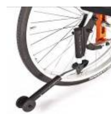
LFT090004 Ruotina antiribaltamento swing away
