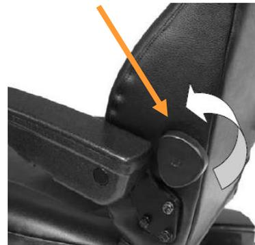
Palanca ajuste inclinación del respaldo
