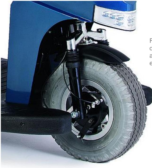
Freno de mano en la rueda delantera y maneta de accionamiento junto a la empuñadura izquierda
