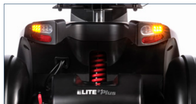
Elite 2 Plus oferece uns resultados de condução imbatíveis graças a seu avançado sistema de suspensão, que permite um movimento de até 85 mm na suspensão traseira e 50 mm na dianteira.
