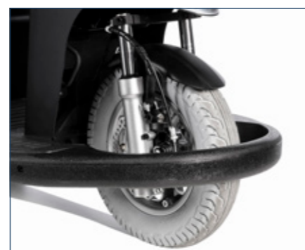
Rodas grandes de 14" com jante de alumínio e alto perfil para incrementar a tração. Amortecedor dianteiro e travões de disco.
