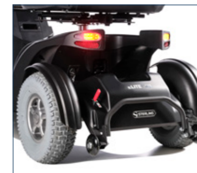
Suspensão traseira ajustável, guarda-lamas, rodas anti volteio e pára-choques traseiro de serie.
