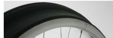
Aros Max Grepp antideslizantes – sin separación entre el aro y la rueda
