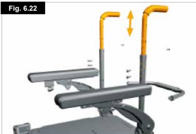
7. Remplacez les vis de réglage des tubes du dossier. Serrez au couple de 10 Nm (Fig. 6.23).
