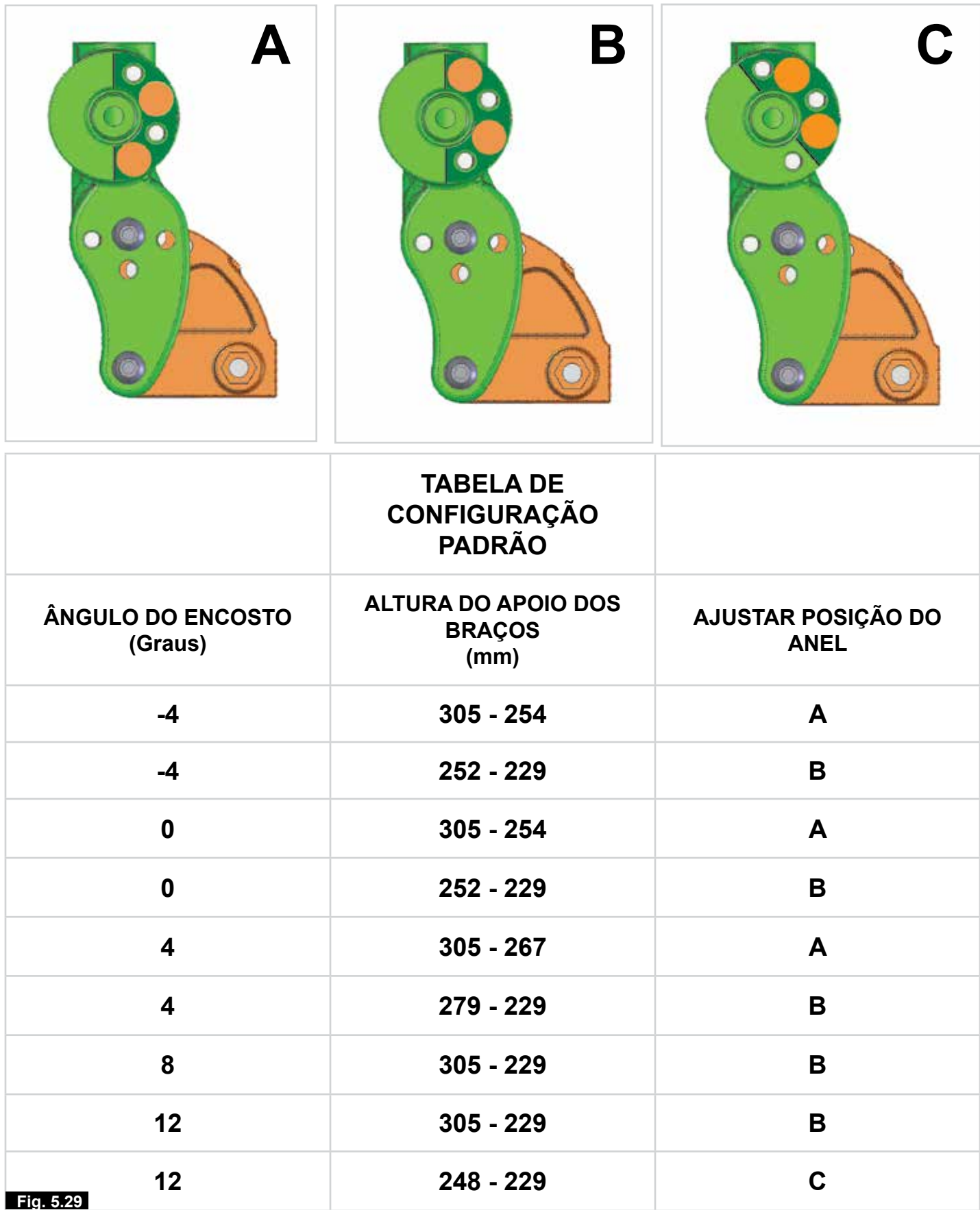
Taboça Mostrando o Ângulo do Encosto - Altura do Apoio de Braços e Posição do Anel de Configuração Correspondente
