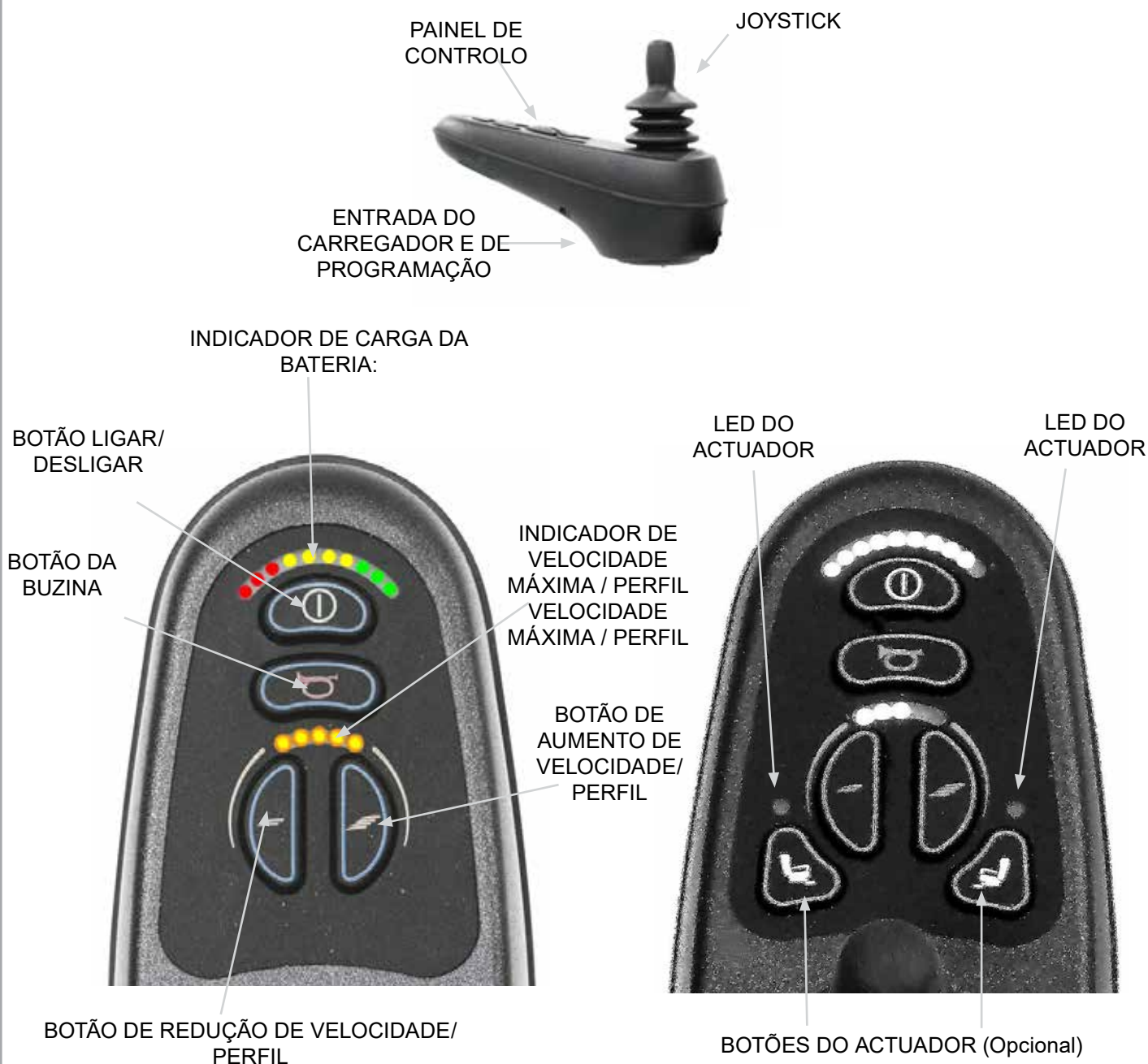
ESQUEMA DO PAINEL DE CONTROLO VR2
