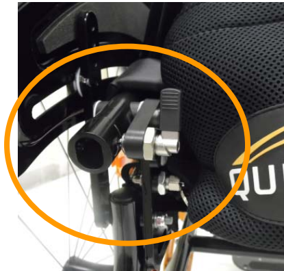
Palanca hacia arriba: respaldo bloqueado. No se puede levantar el respaldo
