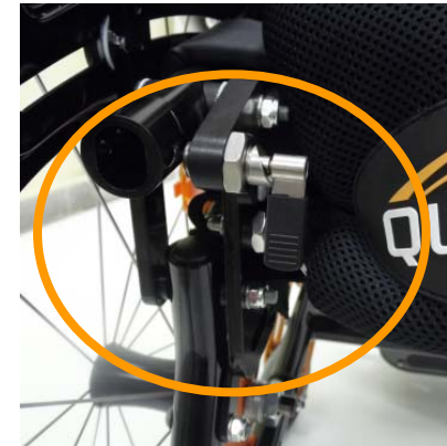
Palanca hacia abajo: respaldo liberado.
