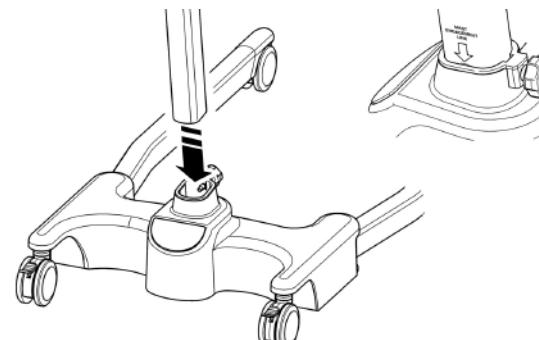
3. Ziehen Sie den Mast mit dem Mast-Feststellknopf fest, der sich vorne am Rahmen befindet.
