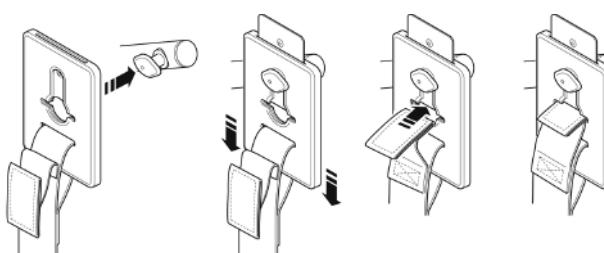
**Sistema de fijación de eslinga Securi3.** Ejemplo de instalación.
