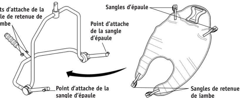
**Châssis à 4 points de fixation** ; Exemple d'une courroie pour châssis à 4 points dotée d'attaches sécuritaires.
