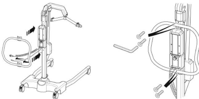
6. Setzen Sie die Akkueinheit in den Lifter ein und vergewissern Sie sich, dass der Verschluss, der die Einheit an ihrem Platz hält, vollständig eingerastet ist. Die Einheit muss mit einem klickenden Geräusch einrasten.
