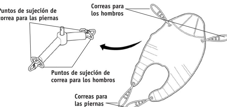
**Barra de extensión de 6 puntos;** ejemplo de la barra de extensión de 6 puntos con sujetaciones de bucle.
