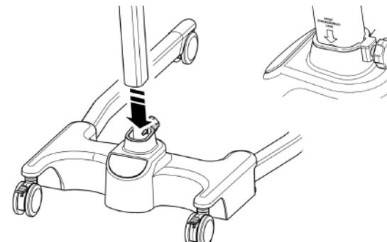
3. Resserrez le mât à l'aide du dispositif de verrouillage du mât situé devant le châssis.
