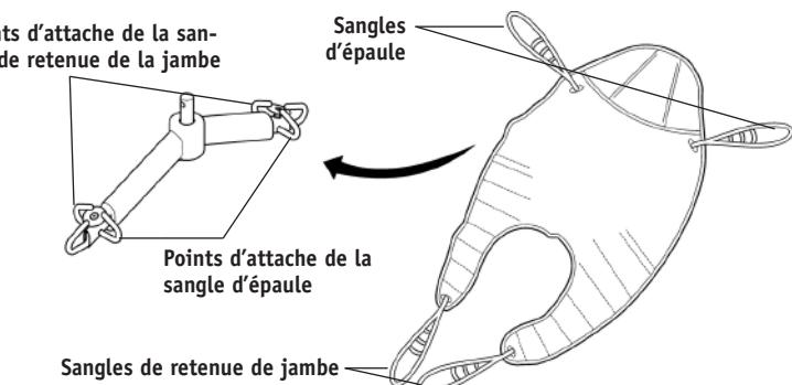
**Barre d'écartement à 6 points** ; Exemple d'une courroie pour barre d'écartement à six points munie d'attaches en boucle.
