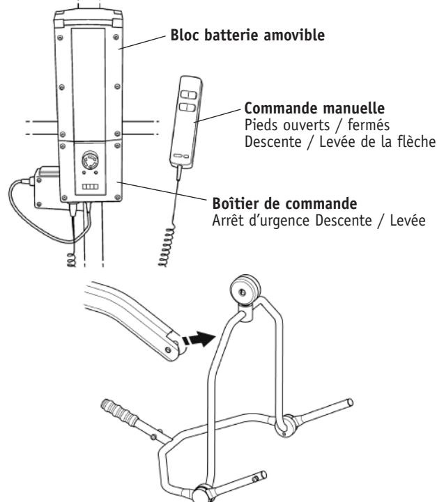
Lorsque le bloc d'alimentation doit être rechargé, retirez-le du lève-personne et branchez-le sur le chargeur autonome.
