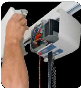
1 Enkel service og lett tilgang til sikringer.
