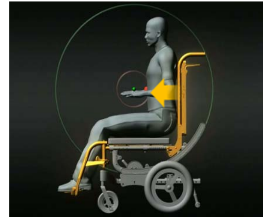
El centro de gravedad del usuario se mantiene alineado con el centro de rotación de la silla
