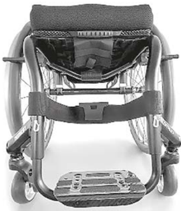
Markierung der Position des vorderen Rückhaltesystems
