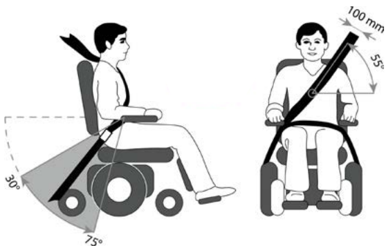
Bild 3: Befestigungswinkel des Beckengurtes
