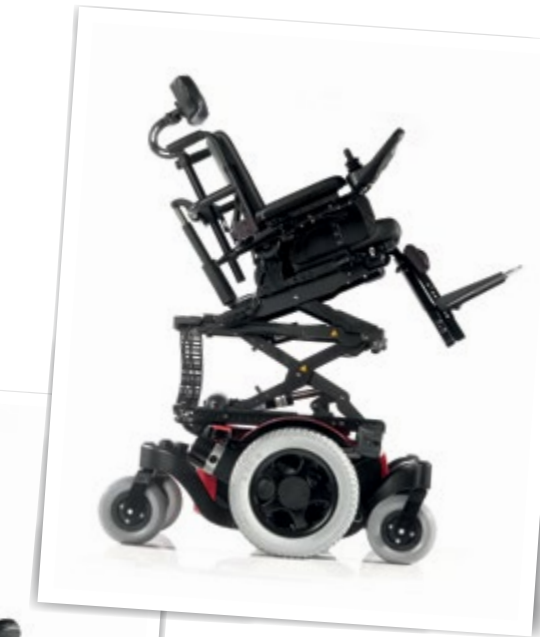
Elektryczny moduł unoszenia i przechylenia środka ciężkości, pozwalający uzyskać prawidłowe wyważenie użytkownika
