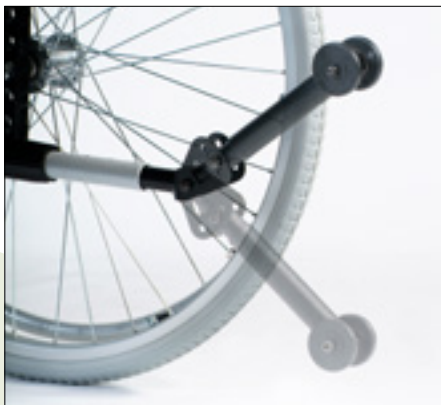
Roulette anti-bascule, escamotable et réglable.
