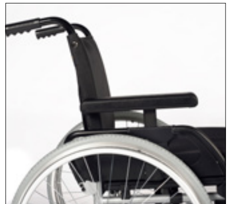
Accoudoir réglable en hauteur avec manchette réglable en profondeur.
