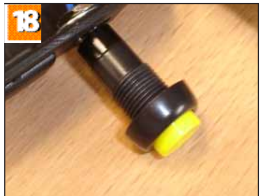
18. Slide out the horn button.
