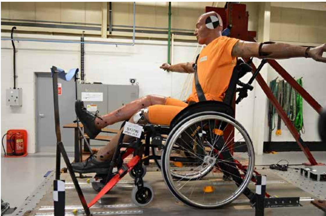
Rullstol säkrad på skenor efter kollision.
