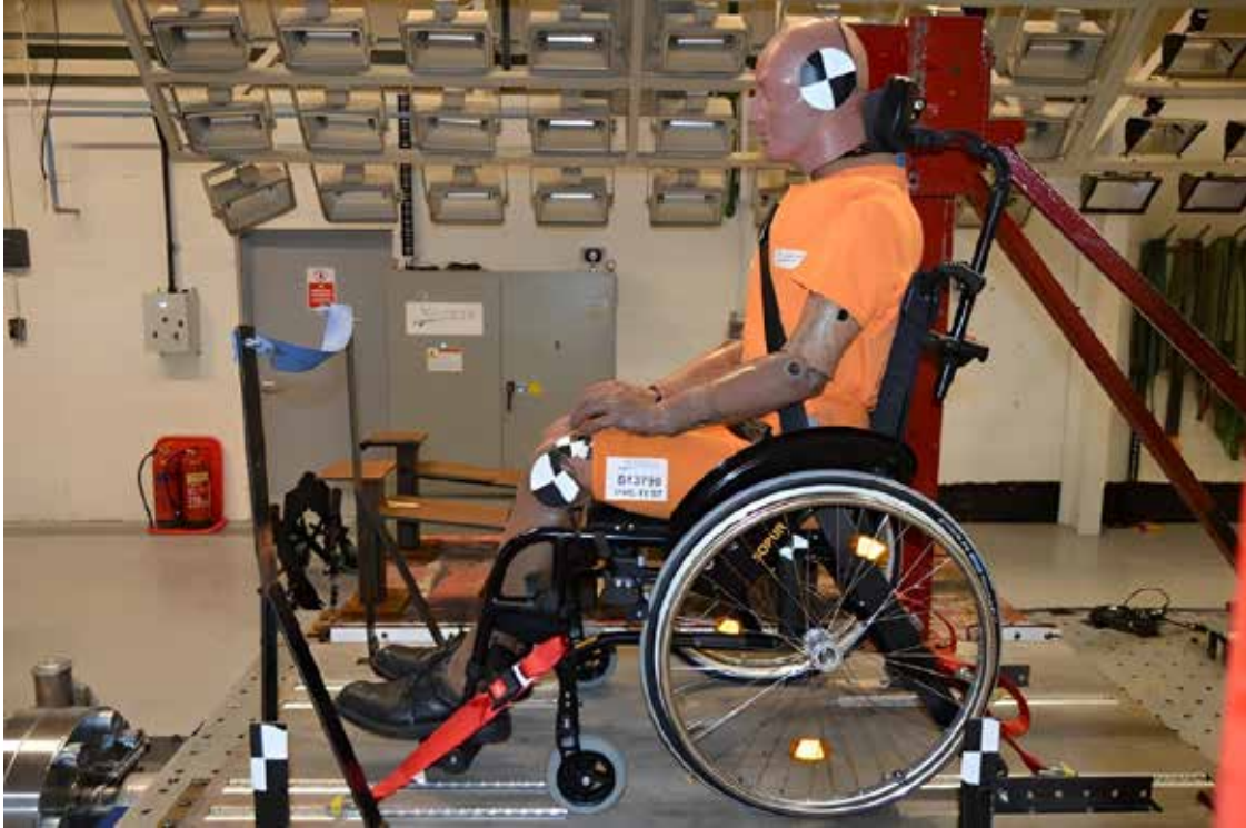
Rullstol säkrad på skenor före kollision.
