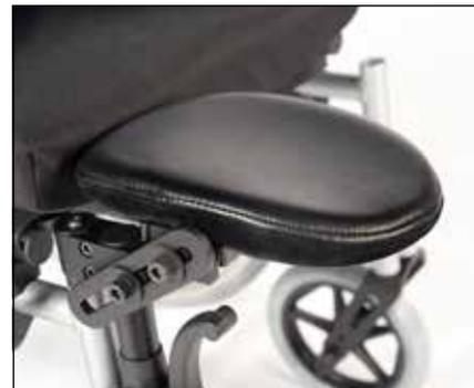
Repose-jambe amputée réglable en inclinaison et en profondeur.
