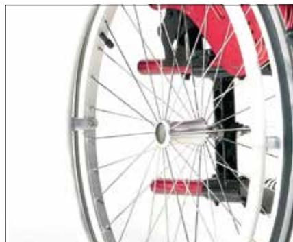
Roues arrière de 24 pouces (à rayons radiaux).
