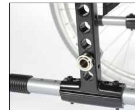
Réglage de la plaque d'axe pour ajuster la hauteur du siège et le centre de gravité.
