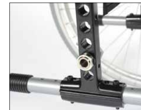
Asplaatinstelling voor zithoogte en zwaartepuntinstelling.
