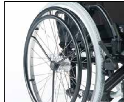
One Arm Drive (links of rechts gemonteerd).
