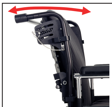
Justerbar ryggvinkel, 12° bakåt och 3° framåt (2). Övre fäste med sidoplatlor väljs efter ryggrörstyp.
