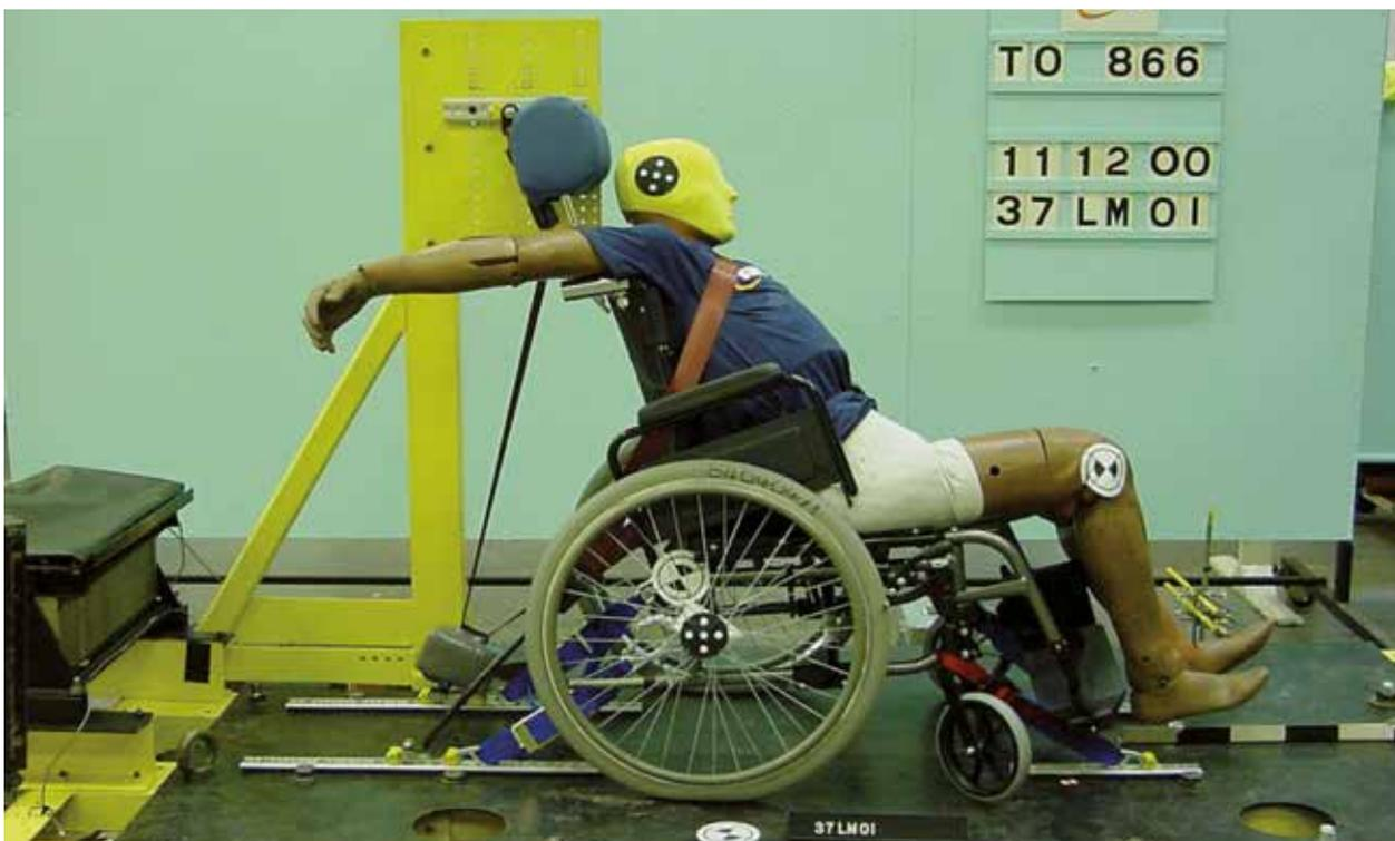
Rollstuhl auf dem Schlitten befestigt, nach dem Aufprall
