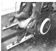
De plaats van de verankeringsband aan de voorzijde van de rolstoel en het verankeringspunt.
