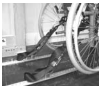
De plaats van de verankeringsband aan de achterzijde van de rolstoel en het verankeringspunt.
