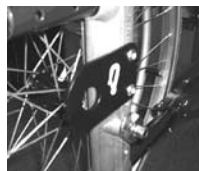
De plaats van de verankeringsband aan de achterzijde van de rolstoel en het verankeringspunt.
