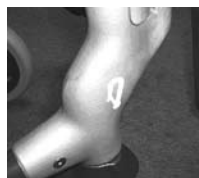
De plaats van de verankeringsband aan de voorzijde van de rolstoel en het verankeringspunt.
