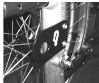
Posizione della cinghia di ancoraggio posteriore e dell'etichetta di ancoraggio sulla carrozzina.
