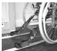
Positionnement du dispositif arrière d'arrimage du fauteuil roulant et de l'étiquette d'arrimage sur celui-ci.
