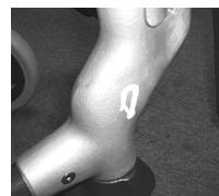
Posizione della cinghia di ancoraggio anteriore e dell'etichetta di ancoraggio sulla carrozzina.
