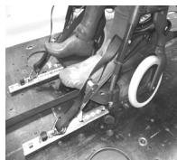
Positionnement du dispositif avant d'arrimage du fauteuil roulant et de l'étiquette d'arrimage.
