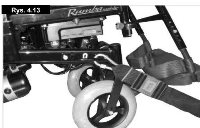
Położenie przedniego pasa mocującego w wózku Rumba Modular, (Rys. 4.13).
