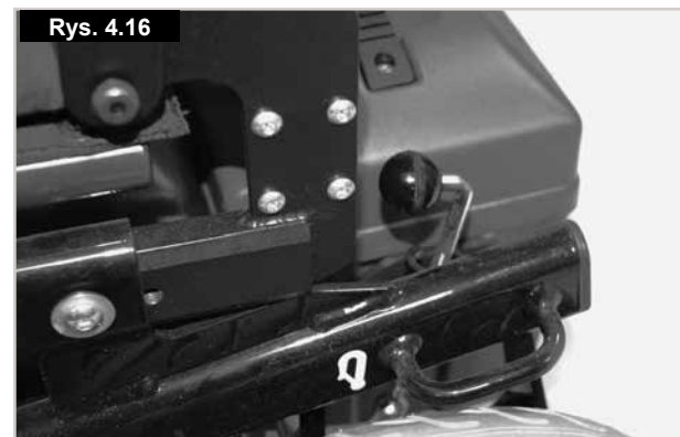
Położenie tylnej etykiety dotyczącej mocowania pasów i wspornika w najnowszych wózkach Rumba oraz Rumba Modular (Rys. 4.16).
