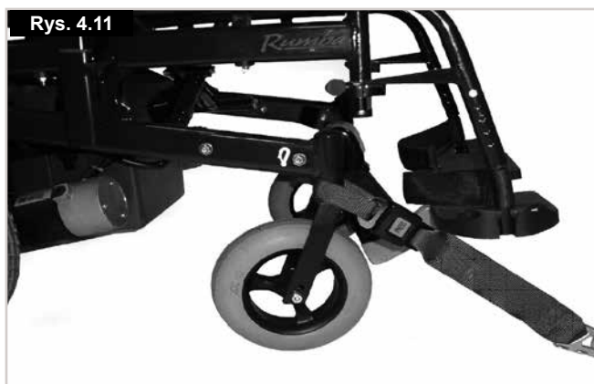
Położenie przedniego pasa mocującego w wózku Rumba, (Rys. 4.11).
