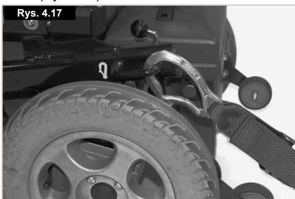
Położenie tylnej etykiety dotyczącej mocowania pasów i wspornika w najnowszych wózkach Rumba oraz Rumba Modular (Rys. 4.16).
