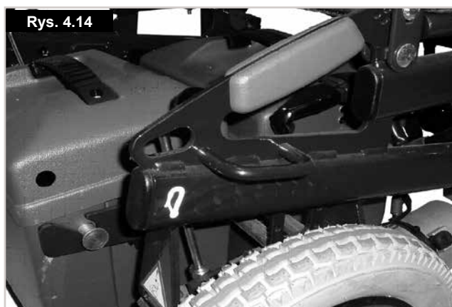
Położenie tylnej etykiety dotyczącej mocowania pasów i wspornika w poprzedniej wersji wózka Rumba (Rys. 4.14).
