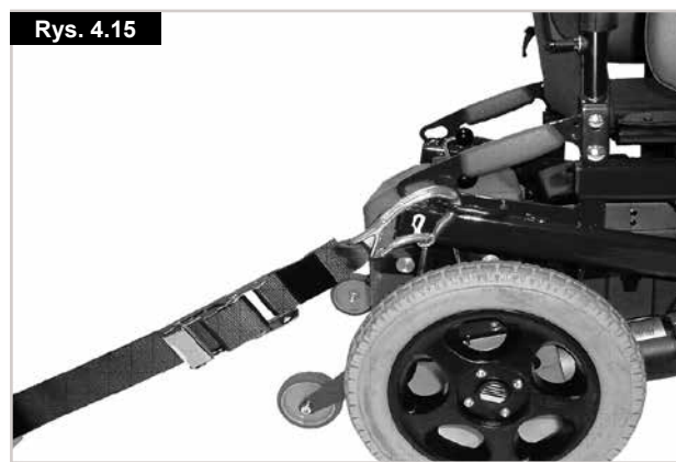
Położenie tylnego pasa mocującego wózek w poprzedniej wersji wózka Rumba (Rys. 4.15).
