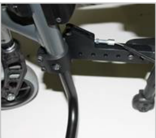
// FMG-MA03-3201-01 Adaptador de -2 a + 6 cm Permite acercar la handbike 2 cm o alejarla hasta 6 cm para sillas con poca profundidad o usuarios altos que necesitan más espacio.
