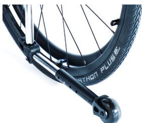
// EAM090004 Sicherheitsrad, abschwengbar
