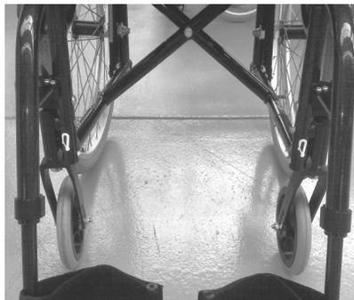
Posizione della cinghia di ancoraggio anteriore e dell'etichetta di ancoraggio sulla carrozzina.
