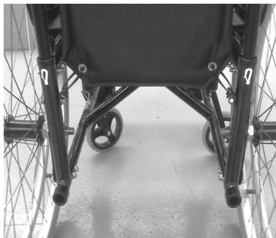
Positionnement du dispositif arrière d'arrimage du fauteuil roulant et de l'étiquette d'arrimage sur celui-ci.
