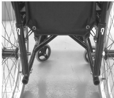
Posizione della cinghia di ancoraggio posteriore e dell'etichetta di ancoraggio sulla carrozzina.
