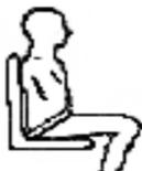
En général, la ceinture sous-abdominale doit être fixée de façon à ce que les sangles soient à un angle d'environ 45°, et quand elle est correctement réglée, elle ne permet pas à l'utilisateur de glisser dans le siège.
