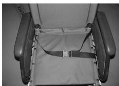
El cinturón de seguridad está instalado en la silla de ruedas tal como se muestra en las ilustraciones. Para colocar el cinturón, rodee con él los tubos del respaldo por el exterior. Para sujetar el cinturón a los tubos del respaldo, utilice el tornillo que sujeta la tapicería al tubo del respaldo. Retire previamente este tornillo. Atraviese con él a la vez el cinturón y la tapicería, y atorníllelo de nuevo al tubo del respaldo, en el mismo orificio.
