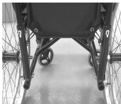
Position des hinteren Rollstuhl-Verankerungsgurtes und des Verankerungsaufklebers am Rollstuhl.
