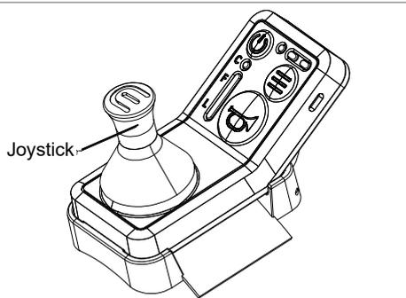
2. Vergewissern Sie sich, dass die Steuerung fest auf dem Steuerungsdock sitzt. Vergewissern Sie sich, dass die Steuerung richtig in die Verankerung und die Verriegelungspunkte eingesetzt ist.
