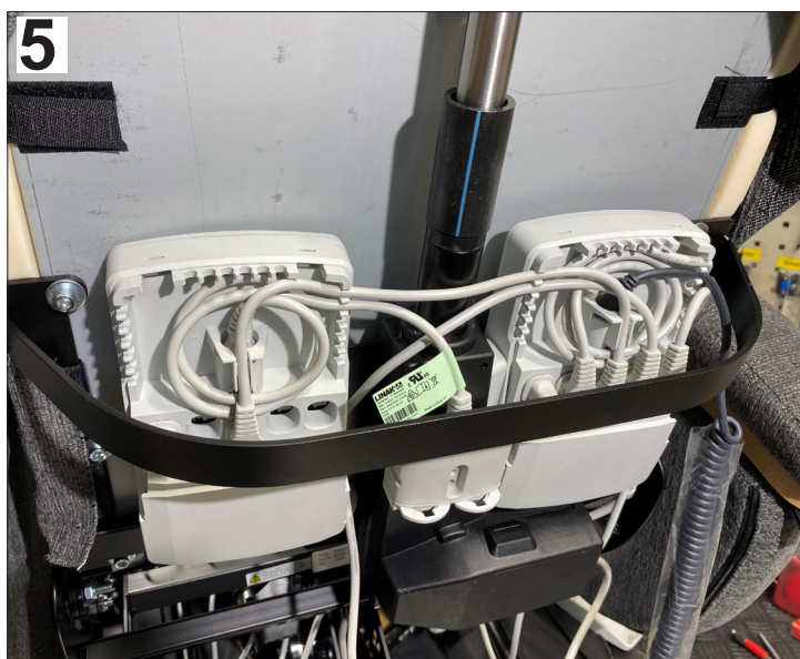
Monter elektronikkboksen bak på opprinnelig elektronikkboks ved hjelp av den medfølgende platen.
