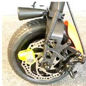
// EMF090166 Diebstahlsicherung, Bremsscheibenschloss
