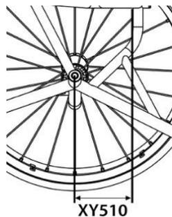
AGAXY515 Centre de gravité réglable par la position du dossier (incompatible avec XE230) (+/-20 mm)
