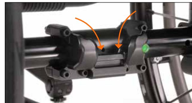
La patte V-LOCK™ effilée guide la R90 dans l'unité de verrouillage et assure un ancrage solide et rapide.
