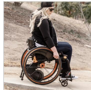
**PROFI TIPP** Wenn Sie am Ende des Gefälles angekommen sind, rollen Sie im Leerlauf, bis Sie die gewünschte Geschwindigkeit erreicht haben und drücken Sie dann die Plus-Taste einmal, um diese Geschwindigkeit beizubehalten.
