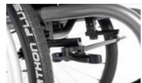
Freno singolo combinato per sistema monoguida ESY060005-6
