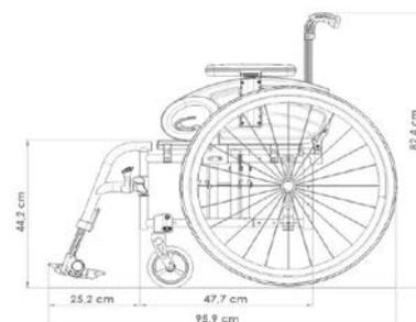
configurazione della carrozzina rappresentata in figura: LS 400 mm e ruote posteriori da 24"
