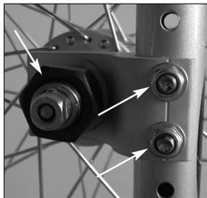
**Das Drehmoment für die abgebildeten Schrauben: 10 Nm
