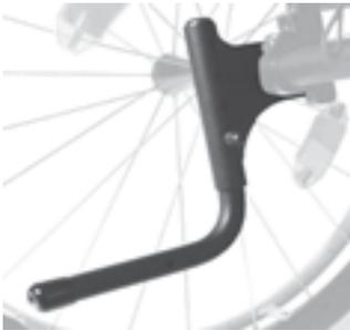
// NTR090001 Levier arrière de basculement
