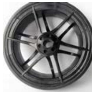
// **Roue avant, bandage (souple), jante: carbone composite (NTR080060):** jante légère, en carbone composite (-80 g comparé à la roue avant, bandage (souple), jante: aluminium)
