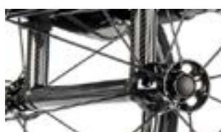
// **Achsbaugruppe superlight, Carbon** (NTR010403) (nur 0° Sturz) (-160g im Vergleich zu NTR010402 Achsrohr, Carbon)
