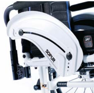
// NTR040103 Protector lateral de aluminio con fender
