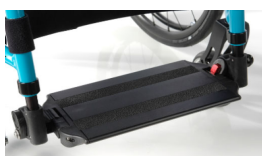
Fotplate, hel, aluminum, vinkeljusterbar, flip-up (sideveis), hælbånd, svart, med låsesystem
