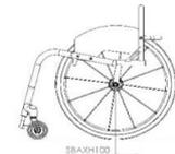
SBTXH130 Châssis arrière carré, centre de gravité réglable (réglable de 25 à 125 mm)
