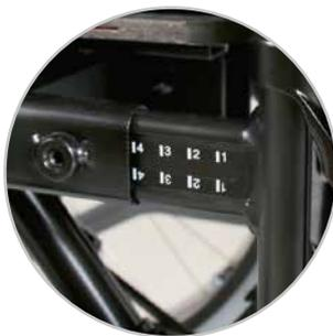
Guías con medidas a ambos lados del armazón, especialmente útiles a la hora de realizar ajustes individuales y cambios de configuraciones.
