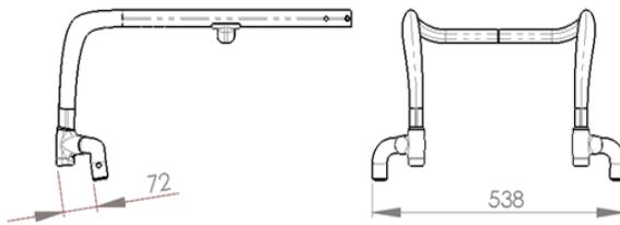
La posizione della forcella spostata in avanti e in posizione larga consente di diminuire la resistenza al rotolamento e di migliorare la stabilità anteriore
