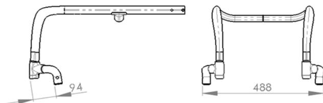
Roues avant positionnées avec 20mm en arrière et de 20mm (par côté) plus à l'intérieur font en sorte que l'avant du fauteuil soit moins large et plus maniable dans les petits espaces.
