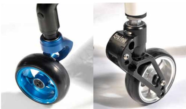
**Horquilla de un sólo brazo u horquilla con suspensión Frog Legs (opcionales).** La horquilla con suspensión absorbe los baches y vibraciones para ofrecer mayor confort y prevenir dolencias a largo plazo, mientras que la horquilla de 1 sólo brazo proporciona robustez con un original diseño.
