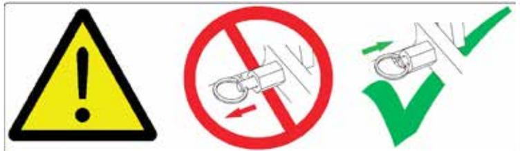
AVERTISSEMENT - La béquille est équipée d'une goupille de sécurité. Lorsque le siège est surélevé, vérifiez que la goupille à ressort soit enclenchée en position verrouillée afin de maintenir le siège en position surélevée en toute sécurité.
