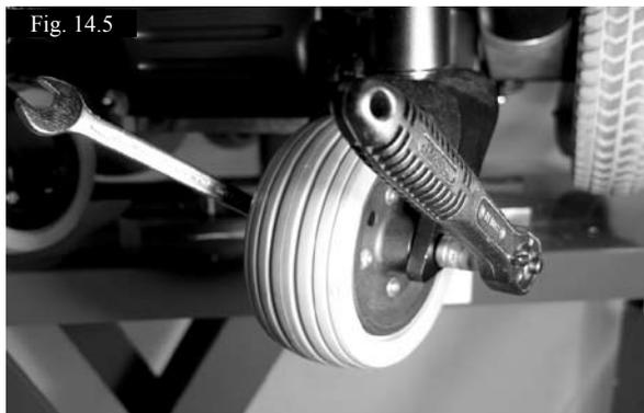
Selon le type de roue avant utilisé, dévissez le boulon d'essieu à l'aide de deux clés hexagonales de 5 mm ou de deux douilles de 13 mm, (Fig. 14.5).
