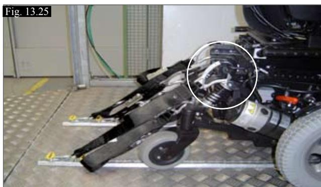
(Fig. 13.25) Emplacement de fixation d'arrimage arrière Utiliser 4 sangles.
