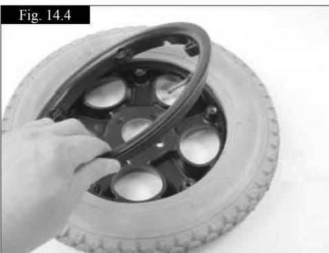
Enlevez la jante interne de la paroi du pneu (Fig. 14.4). Enlevez le pneu et la chambre à air de la jante externe. Attrapez délicatement la chambre à air interne, juste derrière la valve. Sortez délicatement la chambre à air du pneu.
