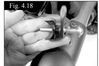
Passez le boulon à travers l'armature du siège. Pour les profondeurs d'assise comprises entre 36 et 46 cm, suivez les indications ci-dessus. Placer le boulon de façon opposée, avec la tête à l'intérieur, pour des profondeurs de siège supérieures à 51 cm (20"), pour éviter un choc avec le support du montant extérieur du dossier (Fig. 4.19)
