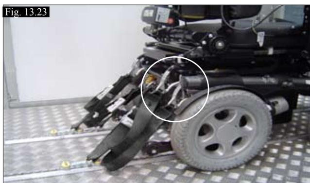
(Fig. 13.23) Emplacement de fixation d'arrimage arrière Utiliser 4 sangles.
