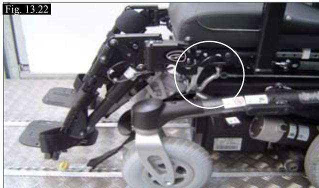
(Fig. 13.22) Emplacement de fixation d'arrimage avant - Options électriques. (Placez les sangles sur le cadre pour les fauteuils sans option électrique, Fig. 13.11)
