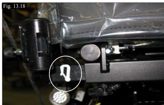
(Fig. 13.18) Fixation d'arrimage sur potence à largeur réglable.
