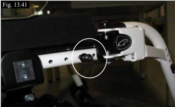
2. RETIREZ LA VIS DE LA POTENCE, (Fig. 13.41) Dévissez et retirez la vis, rondelle (et écrou, si présent) M8 de la potence.
