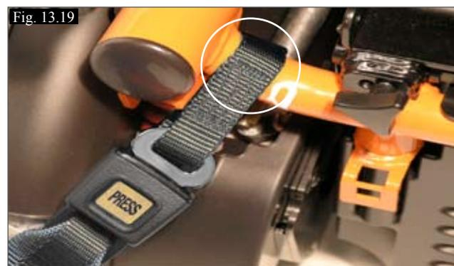
(Fig. 13.19) Emplacement de fixation d'arrimage avant (pas d'option électrique).
