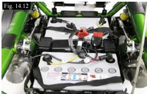
Soulevez le siège et bloquez-le à l'aide de la béquille. Enlevez le cache en plastique du compartiment à batteries, (Fig. 14.12).
