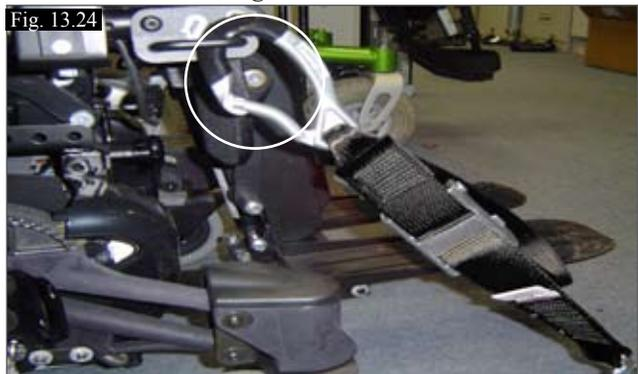
(Fig. 13.24) Emplacement de fixation d'arrimage avant - Options électriques. (Placez les sangles sur le cadre pour les fauteuils sans option électrique, Fig. 13.15)
