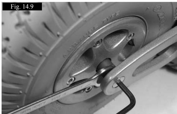
Utilisez une clé hexagonale de 5 mm et une clé ouverte de 13 mm pour retirer les goujons de l'essieu, (Fig. 14.9).
