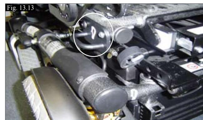
(Fig. 13.13) Fixation d'arrimage arrière pour toutes les options
