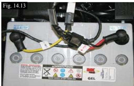
Pour la batterie avant, le câble ROUGE est connecté à la borne Positive (+) et le câble JAUNE à la borne négative (-). (Fig. 14.13).
