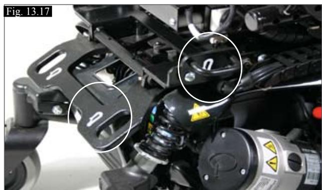
(Fig. 13.17) Fixation d'arrimage arrière pour toutes les options (1 sangle sur chaque).
