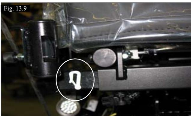
(Fig. 13.9) Fixation d'arrimage sur potence à largeur réglable.
