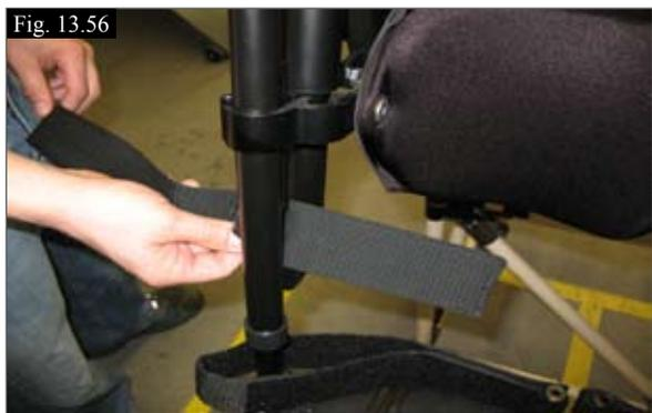
1. Placez les sangles autour de l'arbre de vérin en les faisant passer derrière les appuie-mollets, (Fig. 13.56).
