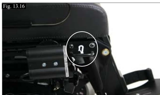
(Fig. 13.16) Fixation d'arrimage avant sur fauteuil doté d'options électriques.
