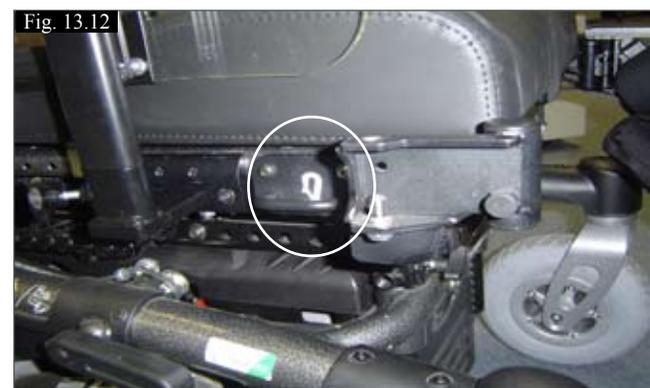
(Fig. 13.12) Fixation d'arrimage avant sur fauteuil doté d'options électriques.
