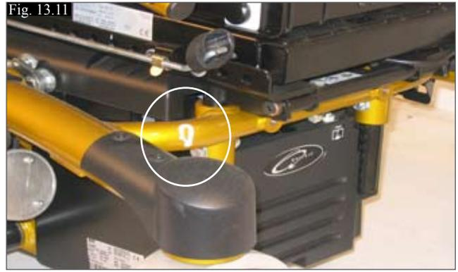
(Fig. 13.11) Pas d'option électrique (pas d'élévation, ni d'inclinaison), fixation d'arrimage avant.
