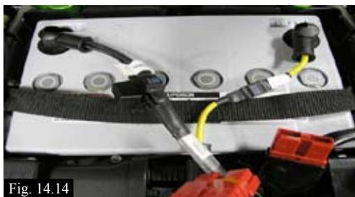
Pour la batterie arrière, le câble JAUNE est connecté à la borne Positive (+) et le câble NOIR à la borne négative (-). (Fig. 14.14).
