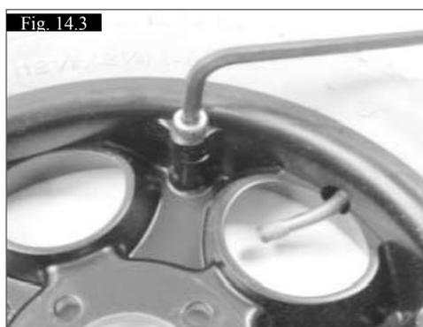
Retirez la roue. Lorsque vous remplacez la roue, utilisez de nouveaux écrous Nyloc.
