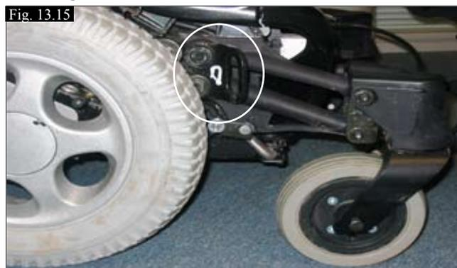
(Fig.13.15) Pas d'option électrique (pas d'élévation, ni d'inclinaison), fixation d'arrimage avant.
