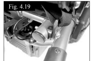
Placez l'autre rondelle-selle à l'extrémité du boulon et contre l'armature. Installer la rondelle et l'écrou. Serrer en utilisant une clé hexagonale 4 mm et une clé 10 mm (Fig. 4.20).
