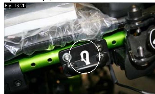
(Fig. 13.20) Fixation d'arrimage avant - Options électriques.
