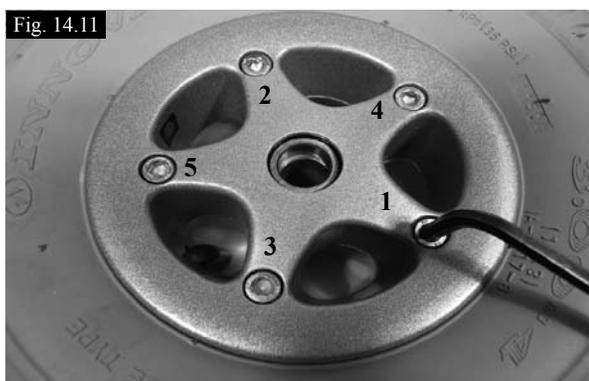
Si le fauteuil est doté de pneus, faites sortir l'air des pneus. Dévissez les 5 goujons dans l'ordre indiqué. Remettez et serrez avec une torsion de 15-20Nm. (Fig. 14.11).
