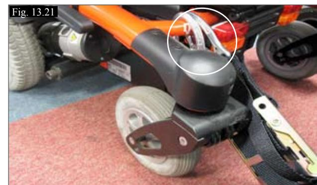
(Fig. 13.21) Emplacement de fixation d'arrimage arrière. Utiliser 4 sangles.
