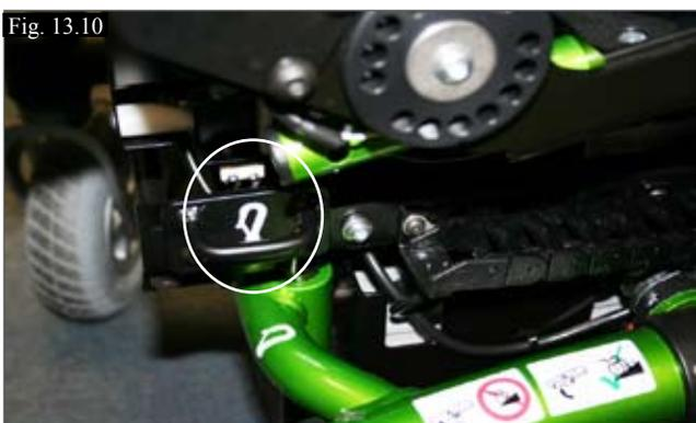
(Fig. 13.10) Fixation d'arrimage arrière pour toutes les options
