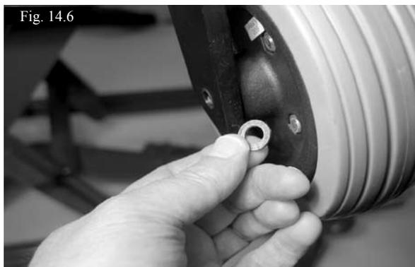
Si le boulon est de type hexagonal, retirez l'écrou Nyloc. Lorsque vous remontez la roue, utilisez toujours un nouvel écrou Nyloc.
