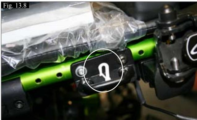
(Fig. 13.8) Fixation d'arrimage avant sur fauteuil doté d'options électriques.
