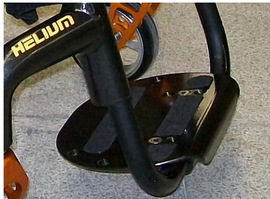
Plataforma de aluminio ajustable en ángulo y profundidad
