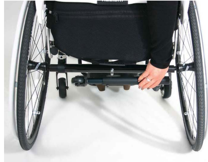
Antivuelco abatible por el propio usuario
