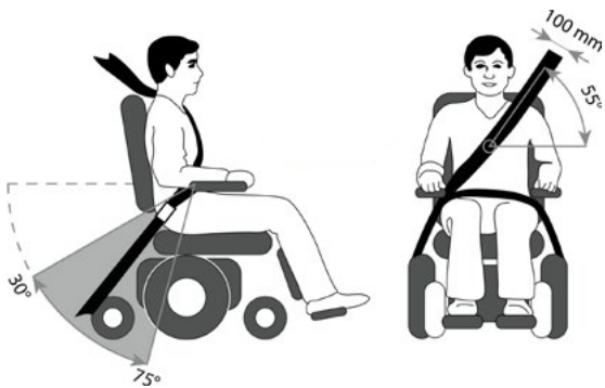
Bild 3: Befestigungswinkel des Beckengurtes
