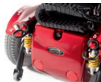
Fácil acceso a las baterías desde la parte trasera de la carcasa (Jive R 2 tracción trasera)
