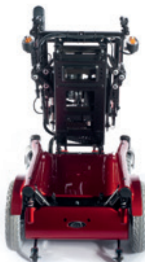
Acceso a las baterías (Jive F tracción delantera)
