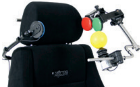
Mando mentoniano con soporte eléctrico y con pulsadores adicionales.
