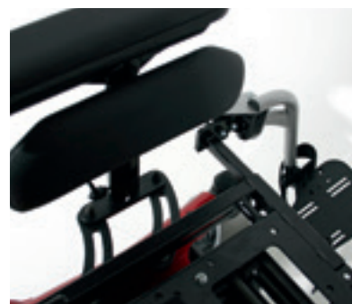
Sistema de asiento ajustable en anchura y profundidad a través del reposabrazos y reposapiés.
