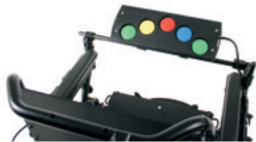
Control mediante pulsadores colocados en bandeja
